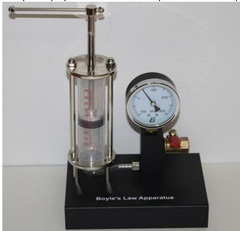
Рис. 1. Пристрій для вивчення газових законів
